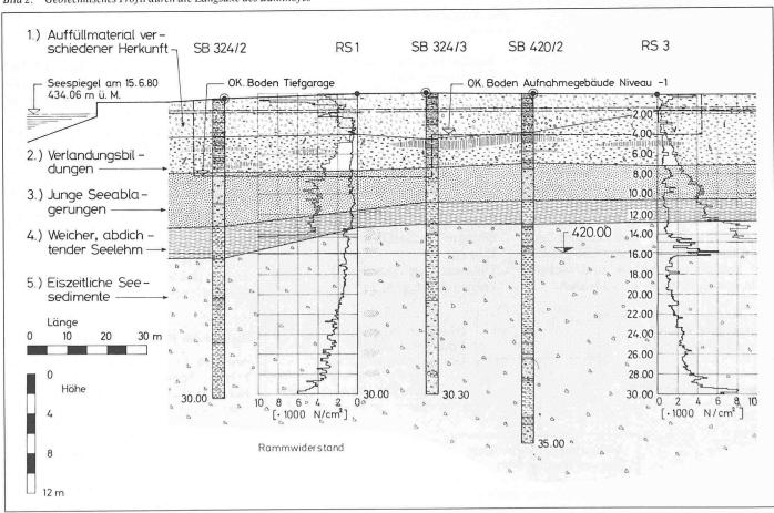
schüttungen. Wie schon in der bestehenden Bahnhofhalle beobachtet werden konnte, unterscheiden sich die Setzungen bei gleichmässiger Belastung und innerhalb verhältnismässig kleiner Bereiche in der Grössenordnung von bis zu 1:5. Eine Setzungsprognose bei Oberflächenbelastungen ist deshalb schwierig und unsicher, da ein genügend enges Sondiernetz zur Ermittlung der örtlichen Setzungseigenschaften der oberen Bodenschichten zu aufwendig wäre.
