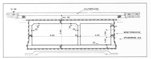
Querschnitt (Nord/Süd) durch Posttunnel (links) und Personenunterführung
