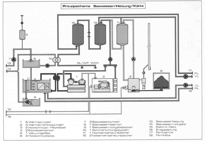
Prinzipschema Wärme- und Kälteerzeugung
