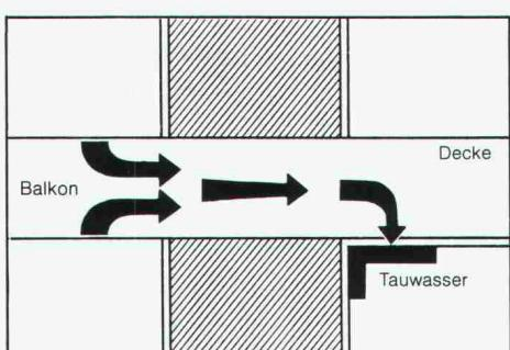
Der Schöck ISOKORB trennt thermisch den Balkon von der wärmeren Deckenplatte ohne statische Beeinträchtigung.
