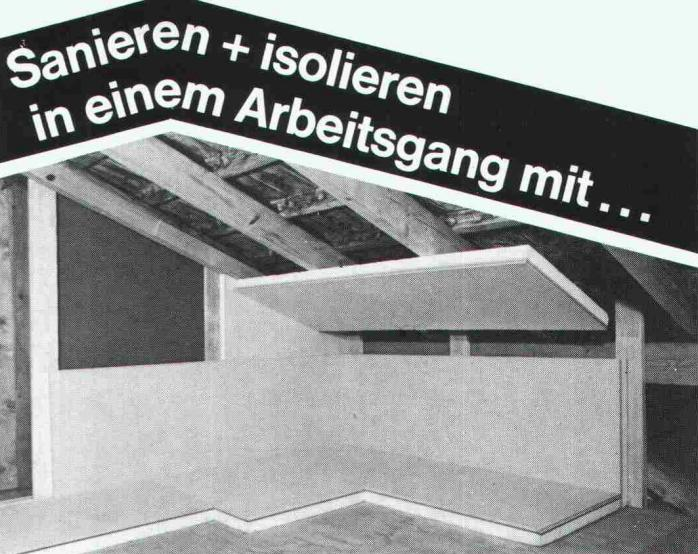
**WESPAN-Normisolierelemente** sind als Boden-, Wand- und Deckenisolierplatten genormt, allseitig genutet und einseitig mit Polystyrol-F20 oder mit Flumrocplatten beschichtet. Div. Platten- und Isolationsstärken. K-Werte bis 0,32 W/m<sup>2</sup> K. Einsparung von ca. 30–50% Arbeitskosten. Isolieren, sanieren in einem Arbeitsgang. Keine Kältebrücken u. Fugen (Nut- und Federverleimung).
