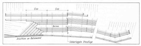
Bild 3. Grundriss der ausgeführten «dabau»-Stützmauer
