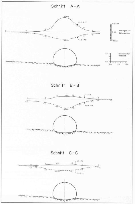
Bild 5. Hebungen und Setzungen im Querschnitt
