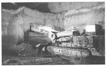
Bild 14. Der AM 100 beim Mittelstrossenabbau
