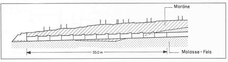
Bild 2. Längsschnitt durch die Möränenzone mit den Gefriersabschnitten
