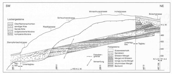
Bild 1.  $Geologisches \ L\"{a}ngsprofil (8 \times \"{u}berh\"{o}ht)$
