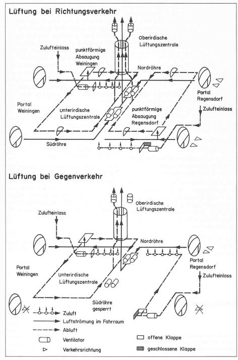
Bild 1. Isometrie mit Lüftungsschema
