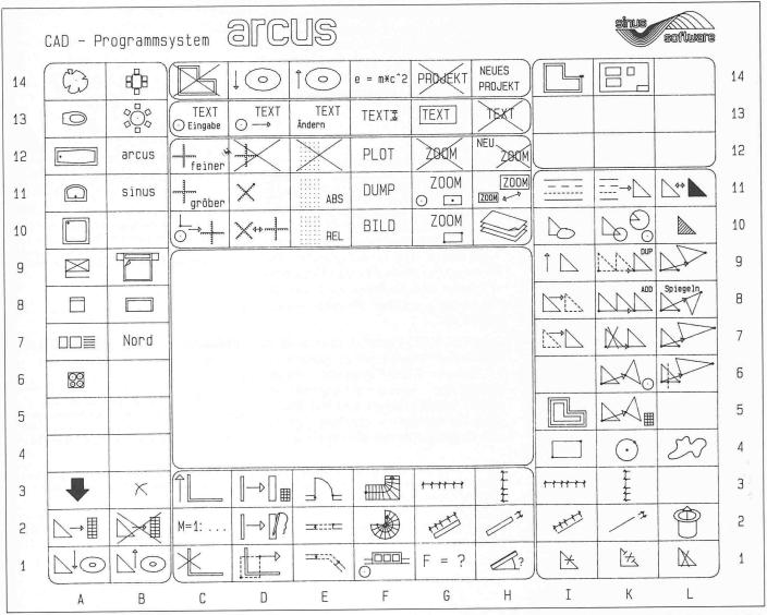
Bild 4. Anhand übersichtlicher Zusammenstellungen sollte sich der Benützer eines CAD-Systems jederzeit über die zur Verfügung stehenden Bearbeitungsmöglichkeiten orientieren können (Quelle: AS-Software Salera + Kuhn, «ARCUS»).
