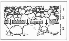
Bild 1. Aufbau eines natürlichen Filters durch Vorlegen eines Gewebes
