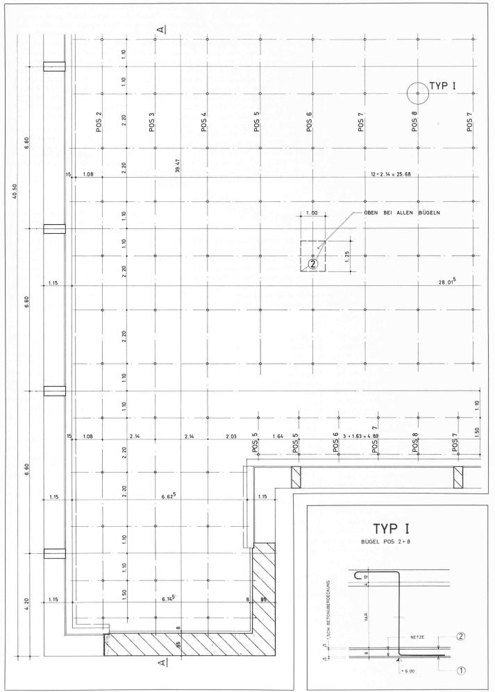
Bild 2. Grundriss der untergehängten Zwischendecke, Ausschnitt
