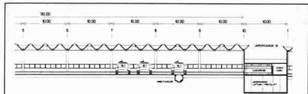
Vaste complexe préfabriqué avec disposition spatiale triangulaire composé de halles respectivement de 60 et 90 m de longueur
