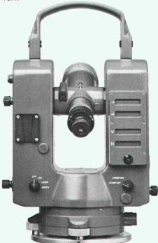
Genau für solche Messpunkte kann der elektronische Sekundentheodolit Kern **E2** eingesetzt werden. Er kompensiert nämlich die Einflüsse von Horizontierfehlern auf Vertikalwinkel und Horizontalrichtungen fortlaufend und automatisch. Und nicht bloss das: nur der **E2** eliminiert die Stehachsschiefe mit Sekundengenauigkeit und in zwei Geräteachsen gleichzeitig.
