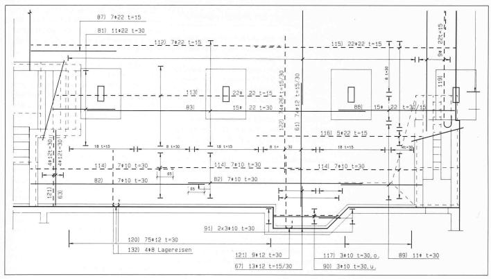
Bild 1. Für die Erstellung der Bewehrungspläne braucht der Bauingenieur die Angaben aus den Architektenplänen nicht mehr von neuem aufzuzeichnen. Diese Angaben können direkt aus der Datenbank übernommen werden. (Quelle: aerni-leuch AG, «Easy Draf 2».)
