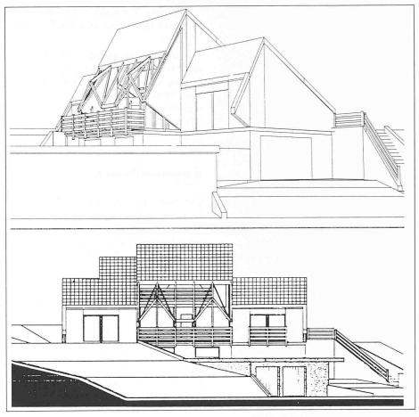
Bild 3. Automatisch gezeichnete Perspektiven und Gebäudeansichten sind bereits in der Phase der Vorprojektierung für das gezielte Gespräch mit der Bauherrschaft verfügbar. (Quelle: ICP S.A., «Star».)
