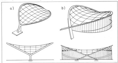
Bild 3. Bogenauflagerkräfte bei einseitigen Belastungen nach [1]
