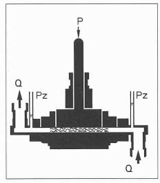
Bild 2. Schema des Permeameters zum Bestimmen der Durchlässigkeit in der Geotextilebene (Pz: Pie-
