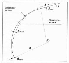
Bild 1. Anpassung der Trägerachse
