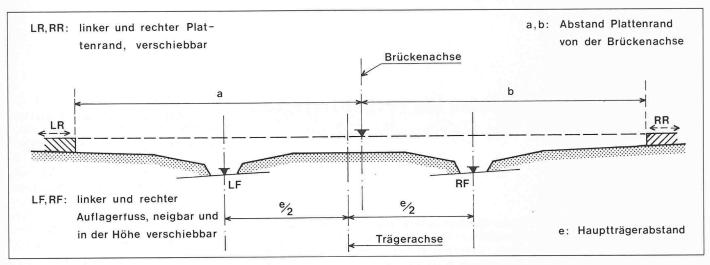
Bild 3. Prinzip der Plattenschalung
