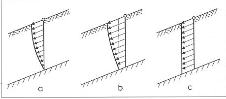
Bild 1. Geschwindigkeitsverteilung in einem Kriechprofil: a) Kontinuierliches Kriechen, b) Diskontinuierliches Kriechen (Kriechen und Gleiten), c) Translatorisches Gleiten; nach [2]
