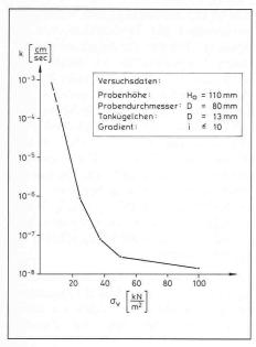
Bild 2. Durchlässigkeitswert als Funktion der Konsolidationsspannung für «trocken» eingebaute Tonkügelchen aus Kaolinit (Lab. Nr. 41127)
