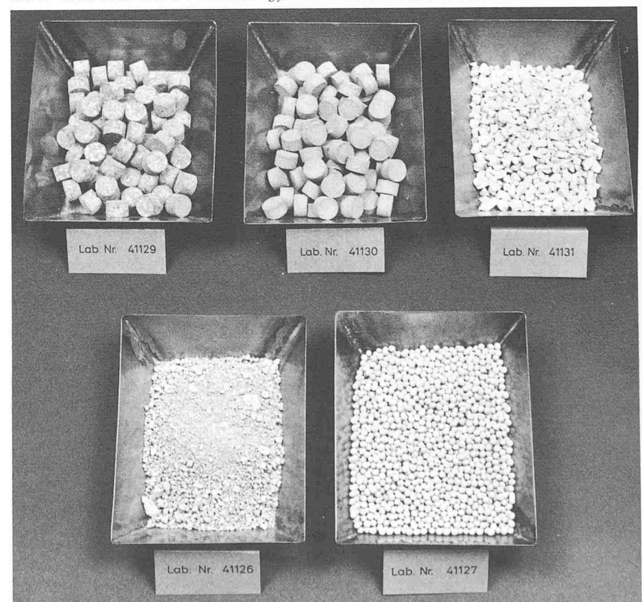
Bild 1. Materialien zur Bohrlochabdichtung für einen Einbau im trockenen Zustand
