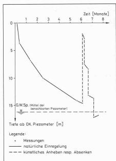
Bild 5. Reduktion der Referenzzeit von Standrohrpiezometern in wenig durchlässigen Böden Beispiel: Piezometer PM 8, Schlammdeponie Gutenswil
