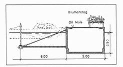
Die schwimmende Hafenmole Tiefenbrunnen in Zürich. Sie besteht bei einer Gesamtlänge von etwa 250 m aus 13 bis 300 t schweren Betonkasten [7]
