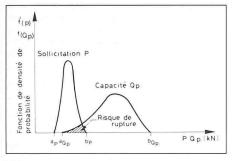
Fig. 9 Capacité portante d'une fondation superficielle
