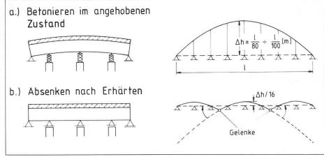
Vorspannen durch eingeprägte Verformungen Bild 1.
