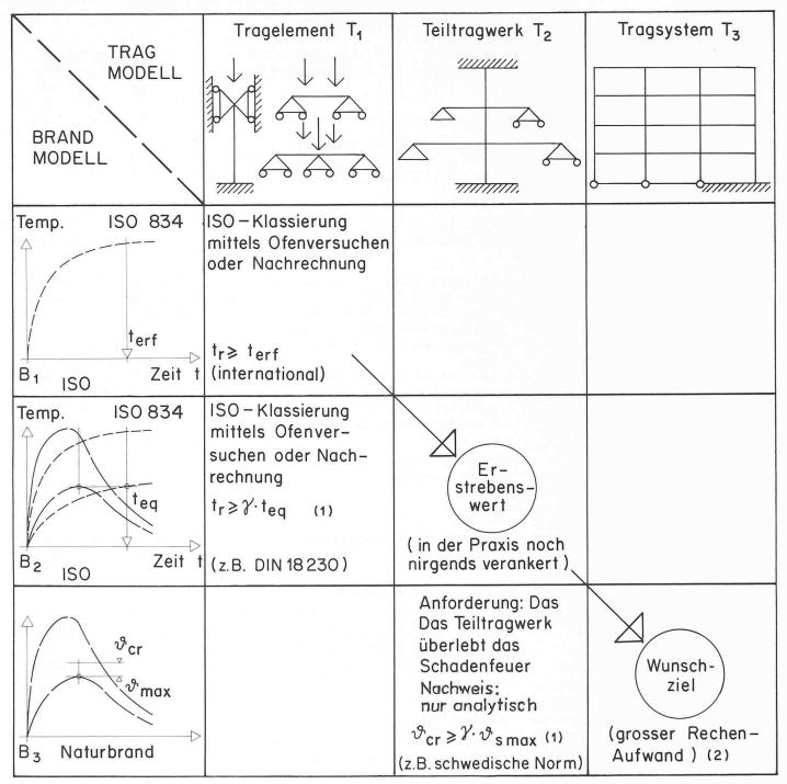
(1) Sicherheitsfaktor  $\gamma$  häufig aufgeteilt in  $\gamma_r$  und  $\gamma_s$ , d.h.  $\gamma = \gamma_r \cdot \gamma_s$
