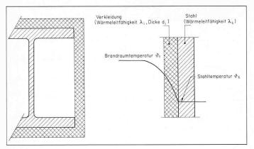
$Bild\ 4. \quad Temperatur verlauf\ in\ einem\ verkleideten\ Stahlelement,\ eindimensionales\ W\"{a}rme\"{u}bertragungsmodell$
