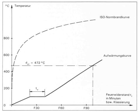
Bild 6.  $Verz\"{o}gerung\ t_v$  in der Temperaturerhöhung des Stahlelementes bei  $Verkleidungen\ mit\ gebundenem$ Wasser
