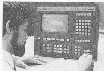
ist sowohl für rechnergestützte Programmierung als auch für Handprogrammierung in der Werkstatt geeignet. Softkeys und zugehörige Menublocks ermöglichen einfache und schnelle Auswahl von Bedienhandlungen. Die Sinumerik 810 wird standardmäßig für die Bearbeitungstechnologien Drehen, Bohren und Fräsen in der ersten Ausbaustufe realisiert.
