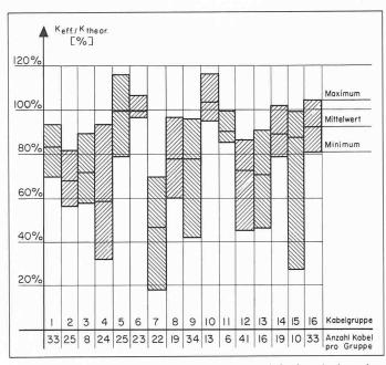
Bild 5. Effektiv gemessene Spannkraft am festen Kabelende in % der rechnerischen Sollkraft
