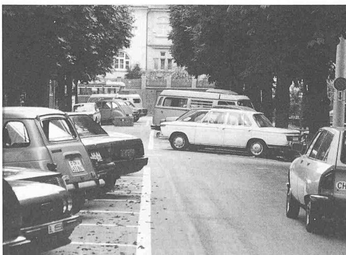
Bild 6. Wechselseitiges Schrägparkieren, Typ D
