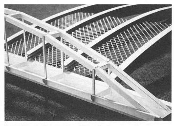
Konstruktionsdetail. Bogenträger mit Sekundärträger
