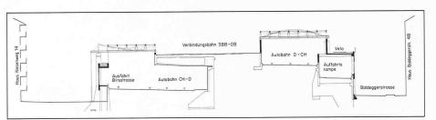
Querschnitt Axe W9 - E7. Links: Kragarm, die Autobahn verschwindet unter dem SBB-Trassee; rechts: Überdeckung Autobahn mit Auffahrtsrampe
