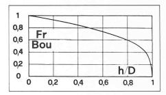
Bild 10. Verhältnis der Boussinesq- zur Froude-Zahl im teilgefüllten Kreisprofil
