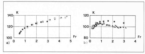
Bild 1. Reibungsbeiwert K nach Gleichung (1) in Abhängigkeit der Froude-Zahl Fr<sub>N</sub> im Rechteckkanal nach Marchi |24|, |25|, |26
