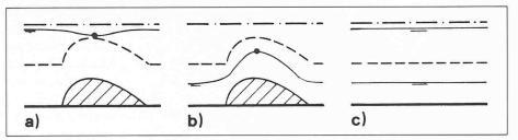
Bild 13. Abfluss über einen wehrförmigen Körper im prismatischen Kanal. Untersuchung der Energiehöhe im Scheitelquerschnitt falls h'=0 (Wasserspiegel parallel zur Kanalsohle) a) Fr<1, h''>0 entspricht  $H_{\bullet}=H_{\bullet, min}$ ; b) Fr>1, h''<0 entspricht  $H_{\bullet}=H_{\bullet, min}$ ; c) Fr>1, h''<0 entspricht  $H_{\bullet}=H_{\bullet, min}$ . Gestrichelt ist der Verlauf der kritischen Abflusstiefe, ausgezogen der Wasserspiegel und strich-punktiert die Energielinie H eingetragen
