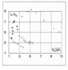
Bild 6. Länge des Wassersprungs  $L/h_2$  in Abhängigkeit von  $V_1/\sqrt{g}h_1$  und  $h_1/D$  nach Kindsvater /22/:  $h_1/D=0,2$  ( $\triangle$ ), 0,4 ( $\blacksquare$ ), 0,6 ( $\bigcirc$ ); volle Zeichen bedeuten durchgehenden Freispiegelabfluss, während offene Zeichen auf Abfluss unter Druck im Unterwasser hinweisen, vergl. Bild 5
