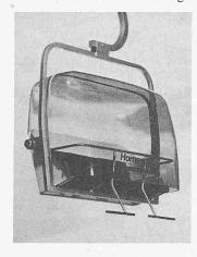
baut. Die Plexiglashaube schützt den Skifahrer vor der Unbill der Witterung. Sie wird vor der Ausfahrt aus der Station automa-tisch geschlossen und bei der Einfahrt wieder geöffnet. Dass der Sessel in der Station abgekuppelt werden kann, ermöglicht dem Fahrgast ein bequemes Ein- und Aussteigen, selbst mit angeschnallten Skiern. Dies ist ein grosser Vorteil gegenüber den bisherigen Sesselbahnen mit fester Klemme, wo sich der Fahrgast der Fahrgeschwindigkeit anzupassen hat.
