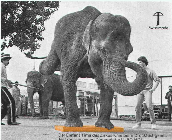
Der Elefant Timo des Zirkus Knie beim Druckfestigkeits-Test mit der neuen Dämmplatte LURO HDF.
