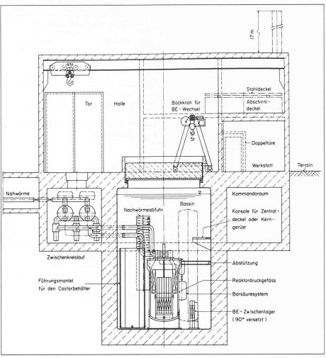
Bild 2. Anlagedisposition des Heizreaktors
