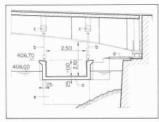
Querschnitt 1-1 durch die trogartige Unterführung: a) Vorgespannter Betontrog b) Zug- und druckfeste Hängestangen c) Aufhängepunkte mit Dämpfungselementen gegen Schwingungsübertragungen aus dem Brückenüberbau d) Stahlstreben zur Übertragung von Horizontalkräften auf das Brückenwiderlager e) Entwässerungskasten (2,70 ×  $2,60 \, m, \, h = 1,40 \, m)$  in Unterführungsmitte
