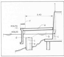
Querschnitt 2-2 durch die Stegkonstruktion a) Bohrpfahl Ø 720 mm mit verlorenem Mantelrohr t = 8 mm b) Vorfabrizierter Betonquerträger c) Betongelenke d) Vorfabrizierte Betonschürze mit Auflagernocken e) Gehweg aus Ortsbeton mit Prelamplatten als verlorene Schalung f) Sitzbänke als
