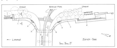
Bild 1. Situation der Gesamtanlage: a) Trogartige Unterführung b) Widerlagerdurchbrüche c) Neue Fussgängerstege d) Verbreiterung der bestehenden Seepromenade mit Sitztreppe e) Stahltreppen
