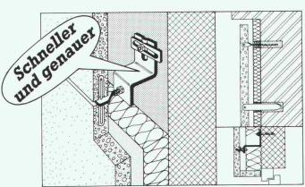
Ankersysteme für Beton und Kunststein, Naturstein, Mauerwerk aussen.
