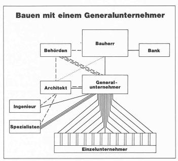
Bild 2. Entlastung des Bauherrn durch den Generalunternehmer. Diese Funktion kann aber von einem Architektur- oder Ingenieurbüro mit einem umfassenden Dienstleistungsangebot ebensogut, wenn nicht besser, übernommen werden.
