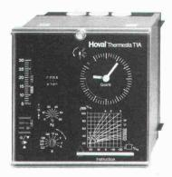
Witterungsabhängiger Regler Hoval-Thermesta Typ T1A für Heizungsanlagen jeder Art und Grösse mit Pl-Verhalten für stetige Mischregelung oder (umschaltbar) mit P-Verhalten.
