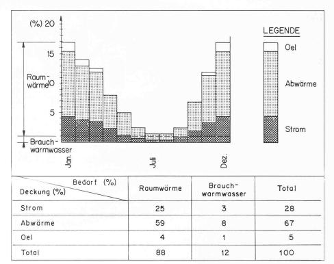
Bild 6. Monatlicher Nutzenergiebedarf und -abdeckung
