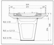
Bild 2. Verbundquerschnitt: Masse in cm
