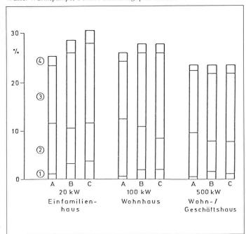
Bild 4. Relative Verbesserung der Jahreskosten infolge besserer Planung bei A konventioneller Öl-Kombi-Anlage, B elektrischer Wasser-Wärmepumpe, C aktiver Solaranlage plus Ölkessel (Einfamilienhaus)
