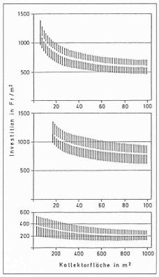
Preise guter aktiver Solaranlagen, fertig installiert [2]; a) Anlagen nur für Warmwasser oder Industriewärme mit verglasten Kollektoren; b) Anlagen kombiniert für Warmwasser und Raumheizung mit verglasten Kollektoren; c) Schwimmbadheizungen mit unverglasten Kollektoren (Absorber für Direktdurchlauf)
