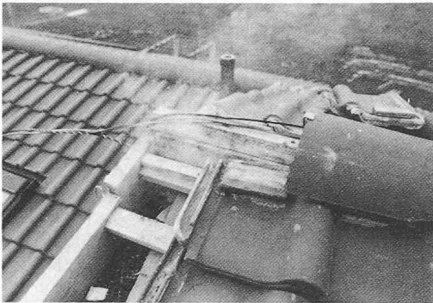
Bild 7. Ortabschluss mit First. Bei entfernten Ortziegeln klar sichtbarer Rauchaustritt als Folge von Luftundichtigkeiten (Rauchprobe)
