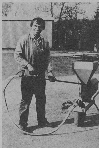
Mobile Pumpe Wangen 15.2 TR mit Zuführtrichter. Einsatz für Ankerpressmörtel
