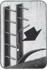
2. Ausschalen – Deckel entfernen – Eisen ausbiegen
