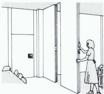
Hüppe Variflex ist ein bewegliches, in Deckenschienen laufendes Trennwand-System. Wartungsfreiheit, hervorragende Schalldämmung und eine Vielzahl an Oberflächenvarianten machen Variflex zum idealen Trennelement für Schulen Mehrzweckhallen, Kulturzentren, Gaststätten und Hotels.
