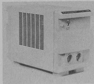
Magnetische Wechselspannungsstabilisatoren sind passive Geräte, die weder Unterhalt brauchen noch irgendeiner Ab-nützung ausgesetzt sind. Sie trennen den Verbraucher galva-nisch vom Netz, sorgen für kon-stante 220 Volt und filtern un-liebsame Störspitzen aus. Ein
