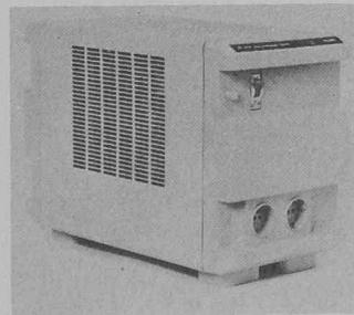
Magnetische Wechselspannungsstabilisatoren sind passive Geräte, die weder Unterhalt brauchen noch irgendeiner Abnutzung ausgesetzt sind. Sie trennen den Verbraucher galvanisch vom Netz, sorgen für konstante 220 Volt und filtern unliebsame Störspitzen aus. Ein
