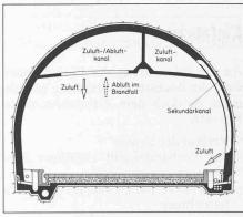
Bild 2. Normalprofil mit kombinierter Halbquer-
