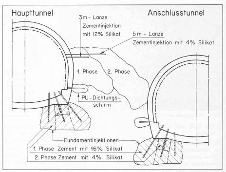
Bild 5. Injektionen zwischen den beiden Tunnels
