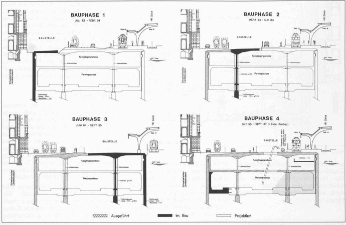
Bild 3. Museumstrasse, Querschnitte mit Bauvorgang, Bauphasen 1 bis 4
