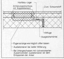
Bild 9. Schwindfugen in Decken
