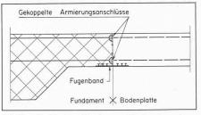
Bild 7. Verbindung Fundament/Bodenplatte
