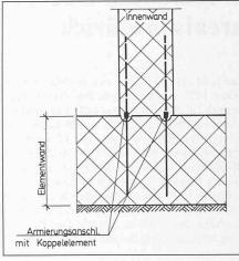
Bild 8. Beispiel eines Wandanschlusses (Horizontalschnitt)
