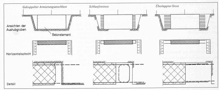
Bild 6. Vertikalfuge. Vergleich der Aushubetappen bei verschiedenen Armierungsstössen
