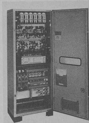
Hierbei gilt als Besonderheit der zwölfpulsige Netzstromrichter, der die beiden um 30° el versetzten Drehstromsysteme in Parallelschaltung auf einen gemeinsamen Zwischenkreis führt, der nachfolgend einen sechspulsigen Motorstromrichter mit besonders verlustarmer Kommutierungsschaltung speist.
