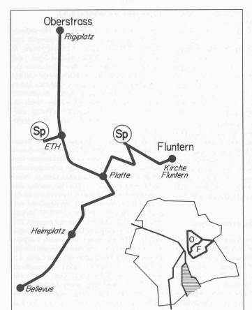
Bild 1. Streckennetz der Zentralen Zürichbergbahn. Sp = Spitzkehren! Die kurze Verbindung Central-ETH wurde erst 1906 nach heftigen politischen Auseinandersetzungen und zwei Abstimmungen erstellt.
