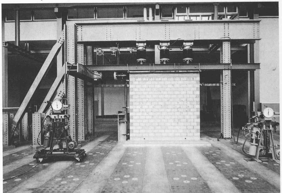
Bild 1. Mauer Nr. 2 aus Backstein der Sonderqualität auf dem Aufspannboden der EMPA. Vertikallast: drei 1-MN-Pressstöpfe, an rechts stehender Presse angeschlossen. Horizontalkraft: ein 1-MN-Pressstopf, mit Presse links. Auf der Mauer: zwei Messrosetten mit vier Messstrecken von 20 Zoll
