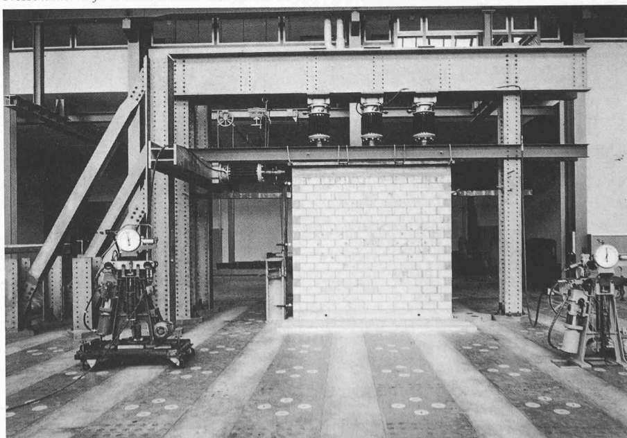
Bild 1. Mauer Nr. 2 aus Backstein der Sonderqualität auf dem Aufspannboden der EMPA. Vertikallast: drei 1-MN-Pressstöpsfe, an rechts stehender Presse angeschlossen. Horizontalkraft: ein 1-MN-Pressstoppf, mit Presse links. Auf der Mauer: zwei Messrossetten mit vier Messstrecken von 20 Zoll
